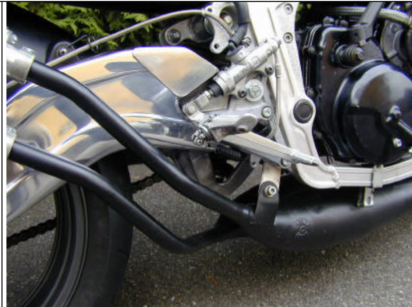
Bild 4.25: Rastenanlage rechts für Hinterradbremse und Auspuffhalterung
