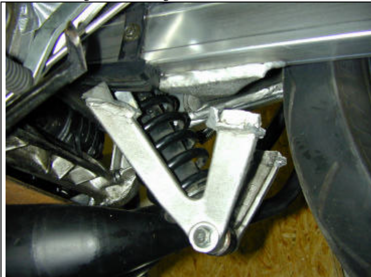
Bild 4.6: Aufnahme, noch nicht angeschweißt
