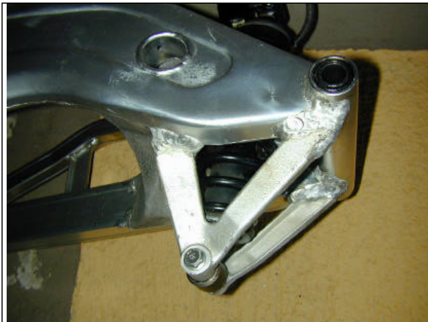
Bild 4.10: fertig geschweißte Bananenschwinge
