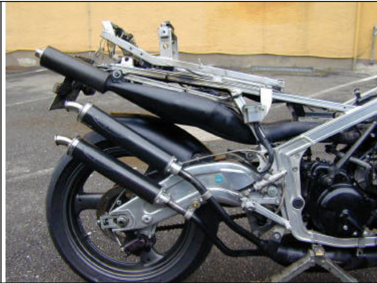
Bild 4.25: Rastenanlage rechts für Hinterradbremse und Auspuffhalterung
