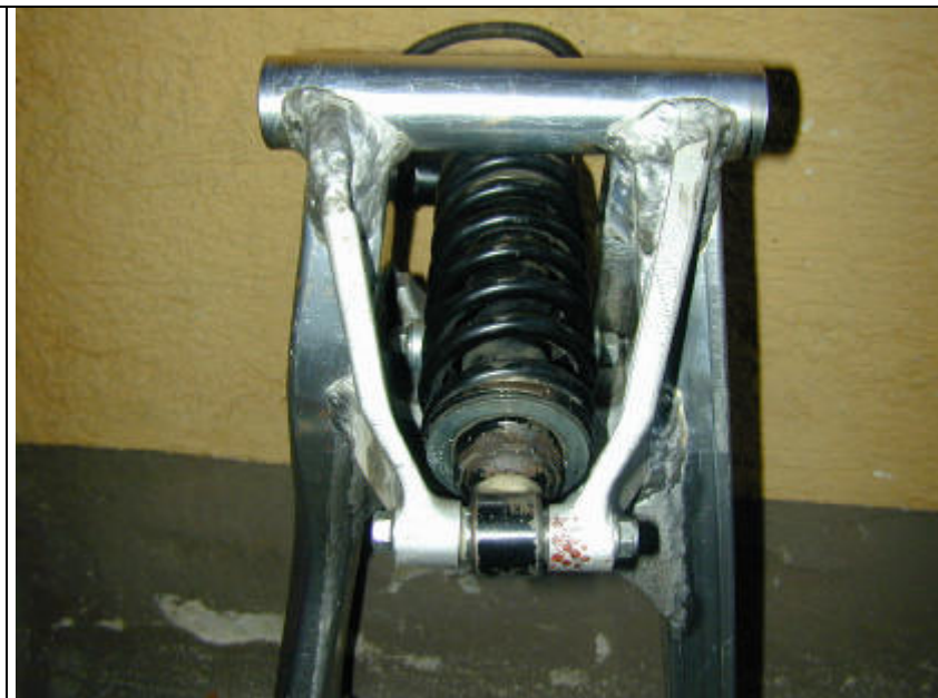
Bild 4.11: fertig geschweißte Bananenschwinge
