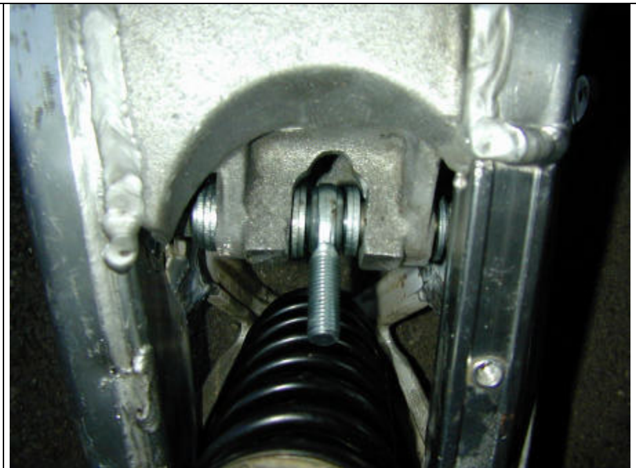
Bild 4.13: Aussparung wurde herausgefräst und Gelenkkopf montiert
