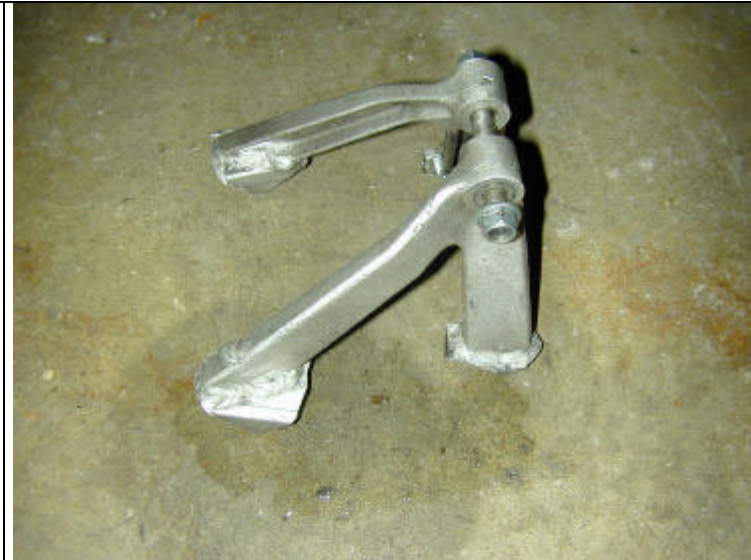
Bild 4.5: Untere Federbeinaufnahme, welche an die Banane angeschweißt wird
