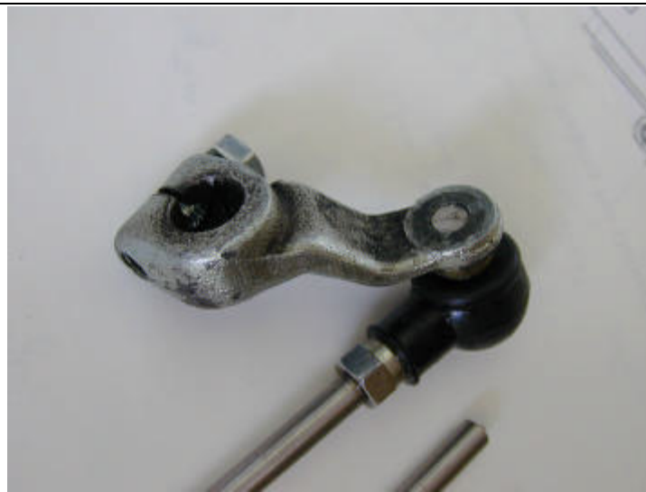
Bild 4.21: Anpassung des Schaltgestänges zur Verwendung der RGV250-Fußrastenanlage am RG500-Rahmen
