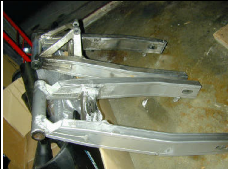
Bild 4.4: Intakte und unbrauchbare RG500-Originalschwinge
