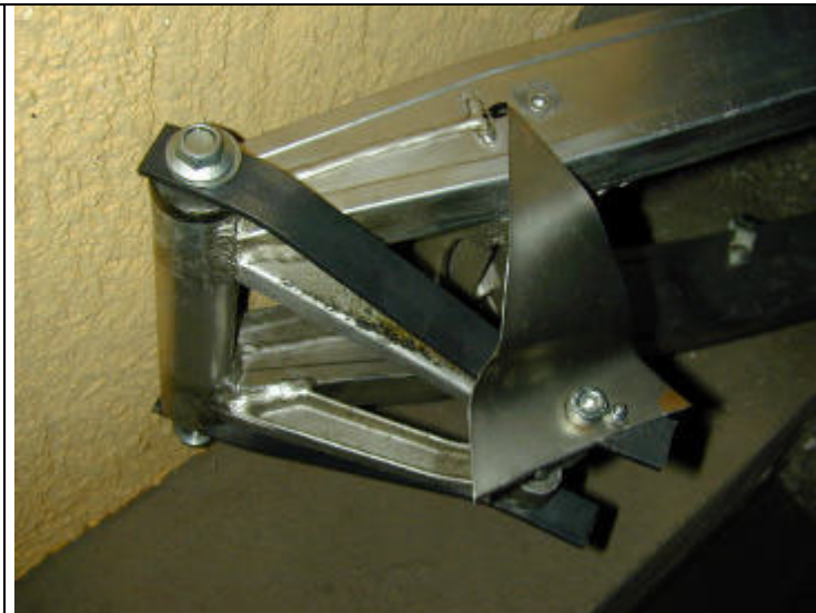
Bild 4.7: Schweißschablone, erzeugt an der intakten Originalschwinge
