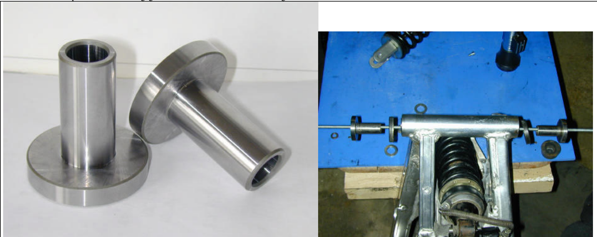
Bild 4.1: Distanzbuchsen zur Verwendung der original RG500-Schwingenachse in RGV250-Bananenschwinge. Bundbreite je 7,5mm
