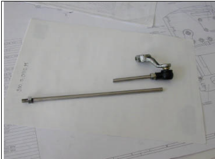
Bild 4.21: Anpassung des Schaltgestänges zur Verwendung der RGV250-Fußrastenanlage am RG500-Rahmen
