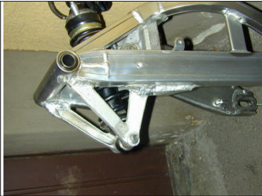
Bild 4.9: fertig geschweißte Bananenschwinge
