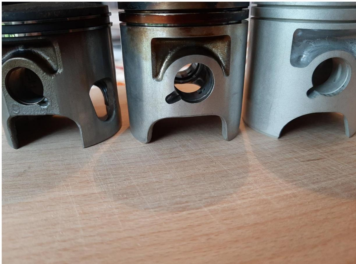
Beide Mitaka Kolben aus England und von der TZR 125 haben gleiche Bauhöhe und müssen mit einer 1,5 mm Aluminium-Fußdichtung im sandwich von 2 Stück 0,5 mm Papierdichtungen verbaut werden.
