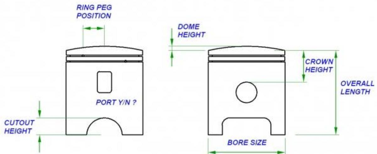
Yamaha DT125 / TZR125 / TDR125 Mitaka Kolbensatz 57,00 mm Abmessungen
