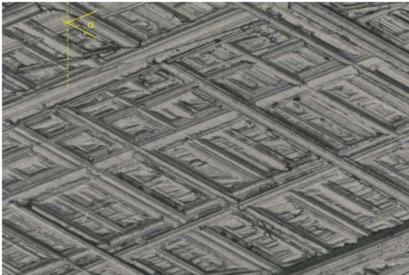
Bild 2: Honwinkel \alpha einer mit keramischen Honsteinen bearbeiteten Oberfläche
